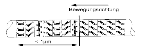
Ab hier reicht die Kraft des Wechselfeldes nicht mehr für die Umpolung aus Wechselfeld der Spule (Momentaufnahme) Abb. 3 Entmagnetisierungseffekt
